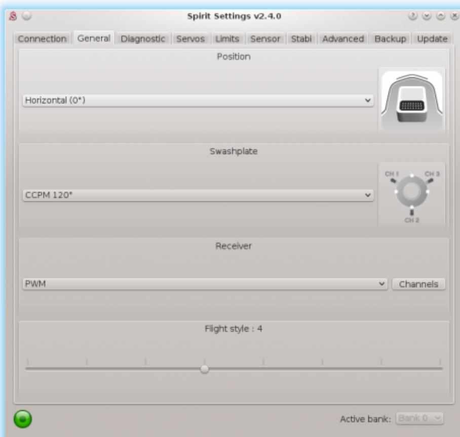
**i** Wann immer Parameter verändert werden, wird der neue Wert sofort angewendet, aber nicht gespeichert. Nur wenn die Einstellungen manuell gespeichert werden, gehen alle ungesicherten Änderungen nach Trennung von der Stromversorgung nicht verloren (s. Registerkarte *Back-up*).
